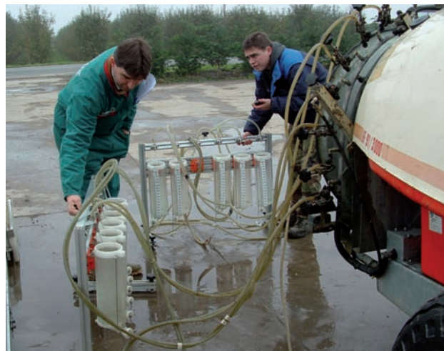
Particolare della taratura (portata degli ugelli) (foto DiSAFA)
